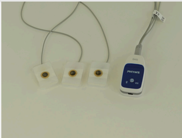
Датчик ЭКГ с тремя электродами
